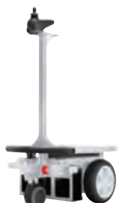
サウザーミニ 積載:60kg 牽引重量目安:150kg 回転半径:約36cm 航続距離:最大15km
