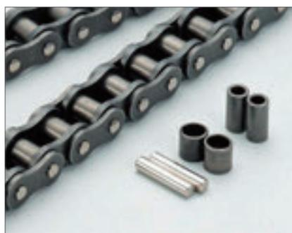
DID焼結ブシュチェーンはブシュが焼結合金のチェーンです。焼結合金の特徴である多孔質空間に予め油を含浸させて潤滑を行い、途中給油が出来ない箇所に適したメンテナンスフリーのチェーンです。
