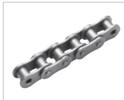
ステンレスローラチェンは300クラスステンレス鋼を素材としたローラチェンで、JIS規格に準拠した寸法で製作しています。酸性、アルカリ性、水のかかる場所及び高温等の耐食性を必要とする場所での使用に適しています。
